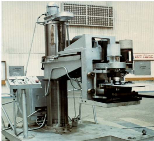
Зачистка кромок перед сваркой
