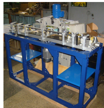
Установка Т15 для МАП труб-оболочек твэлов
